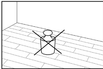
No deben instalarse sobre el suelo elementos que impidan el movimiento natural de dilatación de las lamas por los cambios de temperatura, como podrían ser armarios empotrados, acumuladores eléctricos pesados, muebles de cocina pesados, "islas" de cocina, etc
