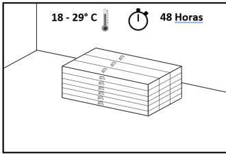
La instalación debe realizarse a una temperatura entre 18 y 29° C.
