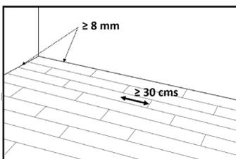
Asegúrese de dejar un espacio de dilatación de **≥ 8 mm** en todo el perímetro de la instalación y con cualquier objeto fijo que pueda impedir el movimiento natural del suelo flotante. La distancia entre los lados cortos de las tablas de las filas contiguas, deben superar los 30 cms de separación entre lados, para asegurar la tracción de esos clics.
