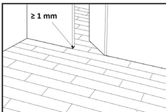
Para la colocación de las puertas después del suelo Tauro, se recomienda dejar un espacio vertical de al menos 1mm entre la base del marco y la superficie del suelo, para que el marco no deje presionado el suelo y éste tenga su movimiento de dilatación.
